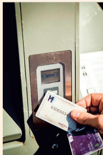
Inovim staat in voor de integratie van een chip of barcode waarmee de hoeveelheid aangeboden afval in kaart gebracht kan worden. © THOMAS DE BOEVER
